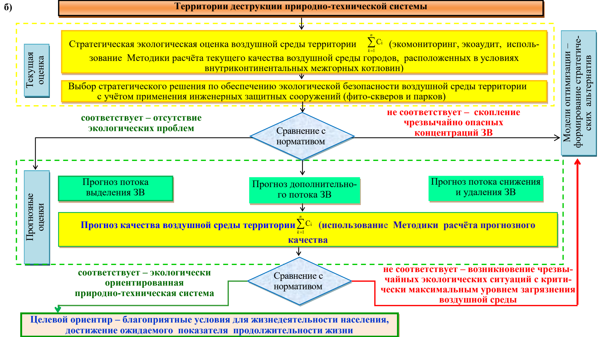
Рисунок 4.8. Принципиальная схема обеспечения экологической безопасности атмосферного воздуха города в условиях межгорных котловин: а) оценка текущей экологической безопасности; б) экологическая оценка на базе рационального выбора и размещения инженерных защитных сооружений
